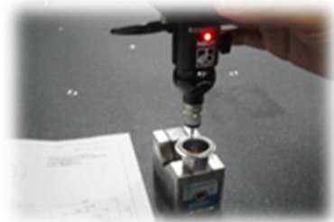
写真 3次元測定器による品質検査
